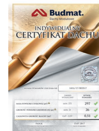
Każda dostępna powłoka posiada ochronną powłokę cynku o gramaturze gwarantowanej i potwierdzonej Indywidualnym Certyfikatem Dachy.
